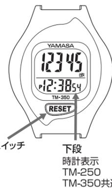
**注意** モード切替目的でリセットスイッチの長押しはしないでください。
