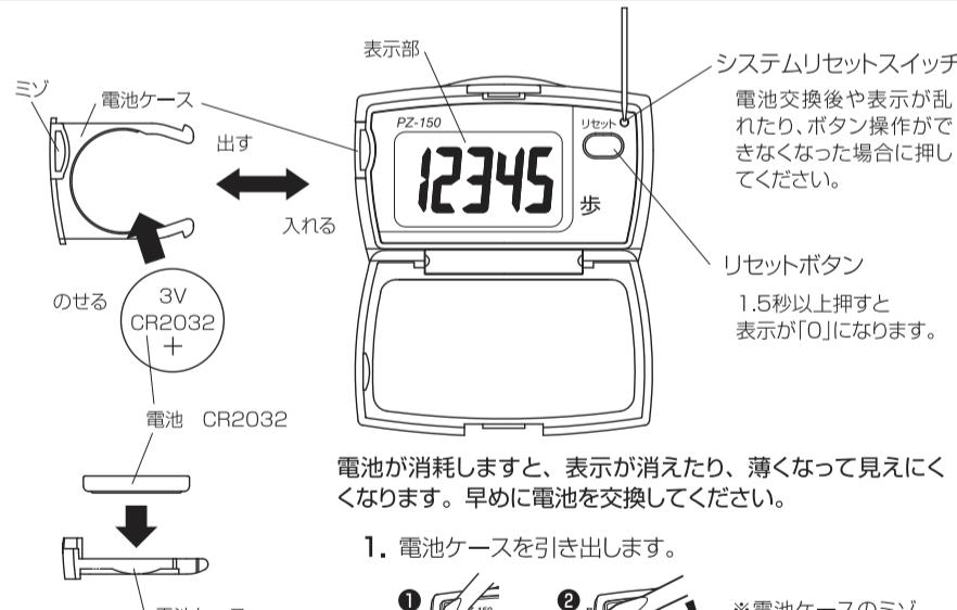
電池交換後は、必ずシステムリセットスイッチを押してください。
